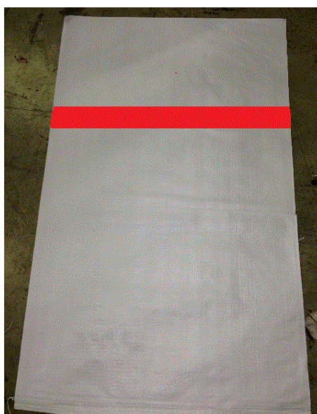
图 4. 带电货物的外装大袋子必须贴上红色胶带
